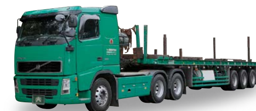
鋼材トレーラ[ボルボ FH16]
